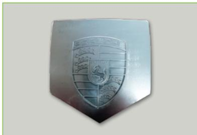
**Werkzeugbau** (Porsche-Wappen): Das Werkzeug prägt das Porsche-Wappen mit Hilfe einer Presse in das Metall. Ähnlich werden auch Teile, wie Türen oder Motorhauben aus einem anfangs flachen Blech geformt.
