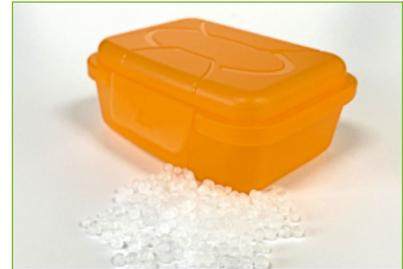
**Kunststoffverarbeitung** (Plastikgranulat und Plastikdose): Um aus Kunststoff Produkte herzustellen, muss Granulat stark erwärmt und in Form gebracht werden. Nach dem Erkalten behält es seine Form, z. B. als kleine Dose.
