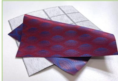
**Textilindustrie** (Mustergewebestücke): Beim Weben von Afrikadamast werden Baumwolle und Polyester verwendet, wodurch der Stoff besser kühlt. Das Beispiel einer technischen Textilie zeigt Stoff, der zur nächtlichen Wärmedämmung vor Kühlregalen im Handel zum Einsatz kommt.
