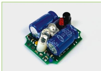
**Sensortechnik** (Sensorbauteil): Das ist die Elektronik für einen berührungslosen Wasserhahn. Ein kleiner Sensor erkennt, wenn eine Person davorsteht. Wenn sich eine Person nähert bzw. eine Hand erkannt wird, fließt das Wasser.
